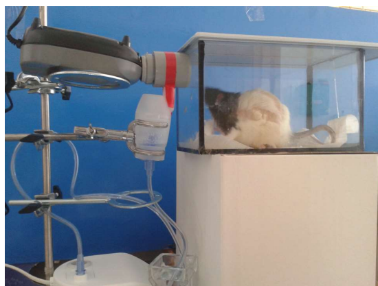
Geneze aerosolu pomocí nebulizátoru OMRON C101 s hermeticky uzavřeným a menším objemem komory zvířete a přídatným pulzním ventilátorem, úplně vpravo histogram velikosti aerosolu bleomycinu.
